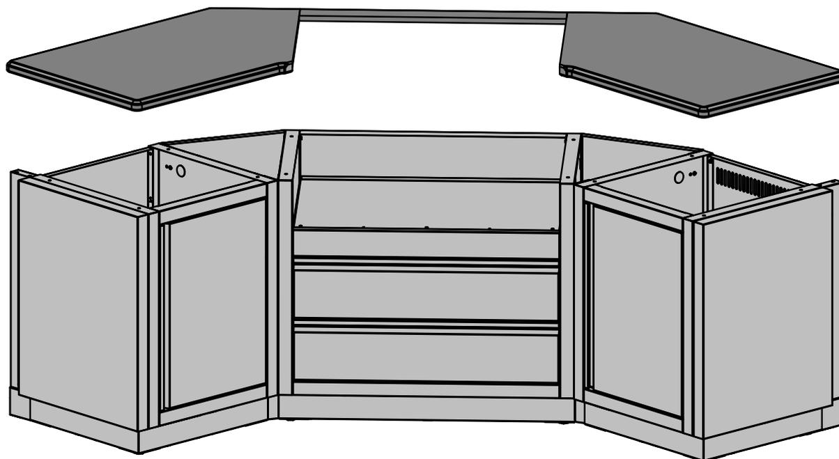
**FIXEZ LE COMPTOIR EN RESPECTANT LES DIRECTIVES DU FABRICANT. DES TROUS ONT ÉTÉ MÉNAGÉS DANS LE REBORD SUPÉRIEUR DES PANNEAUX LATÉRAUX POUR Y INSÉRER LES PIÈCES DE FIXATION.**
