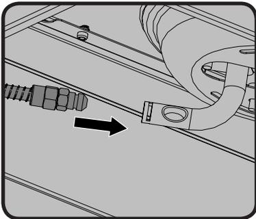
Placez l'orifice dans le brûleur et fixez à l'aide de l'attache de retenue fournie.
