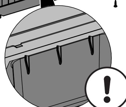
Insérez l'extrémité de la tablette sous les nervures de l'embout.
