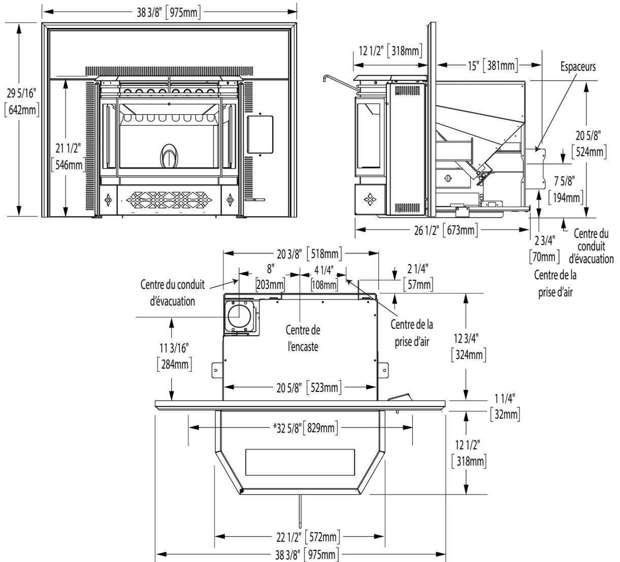
\* L'ouverture avant du foyer ou de l'enceinte doit avec cette largeur afin de pouvoir installer le contour à égalité avec le mur fini et centré dans l'ouverture.
