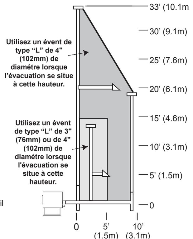
Tous les joints du système d'évacuation doivent être scellés avec de la silicone RTV à haute température et vissés à l'aide de longues vis en acier inoxydable d'au moins 3 3/8" (85,7mm). Scellez chaque joint en appliquant une quantité généreuse de silicone RTV 500 °F (260 °C). Nous vous conseillons de sceller l'extérieur des connexions du système d'évacuation afin de faciliter l'accès lors de l'entretien.
