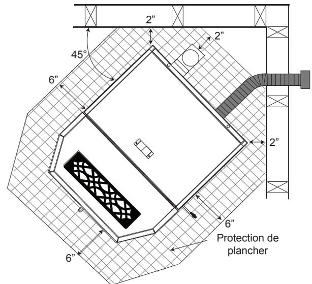
**NOTE :** Si vous utilisez des événements verticaux intérieurs, le dégagement au mur arrière est calculé à partir du raccord en T. Le dégagement variera selon la marque du système d'évents (environ 5" (127mm)). Avant de placer le poêle, branchez le coude ou le raccord en T et allouez un dégagement minimal de 3" (76mm) au mur combustible.
