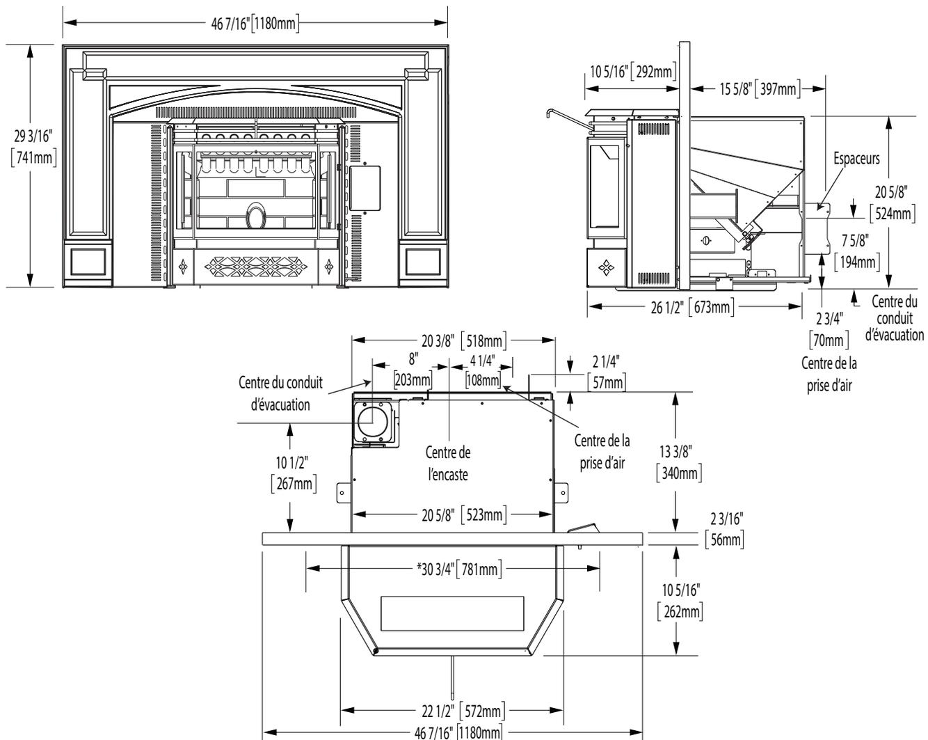
\* L'ouverture avant du foyer ou de l'enceinte doit avec cette largeur afin de pouvoir installer le contour à égalité avec le mur fini et centré dans l'ouverture.
