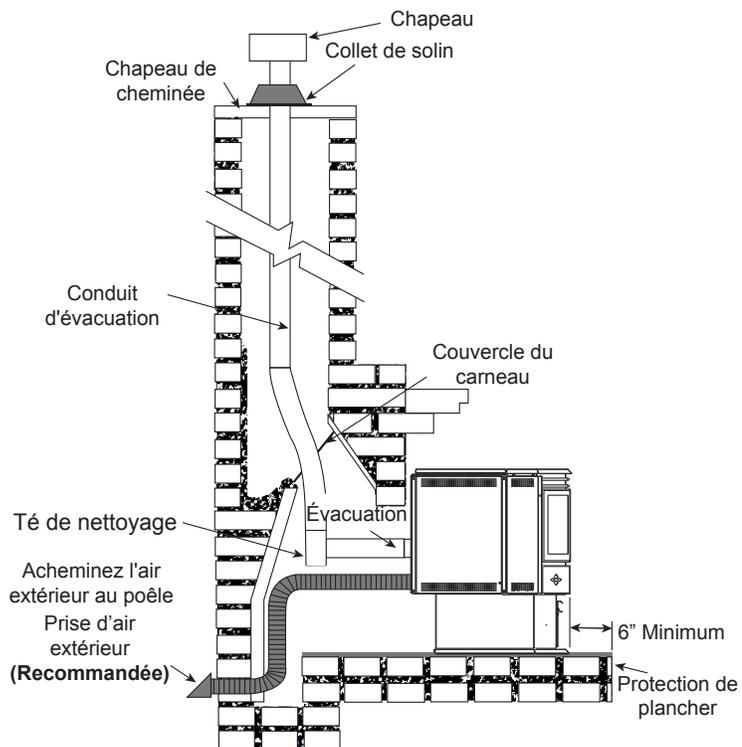
Référez-vous aux directives d'installation du fabricant et aux sections « installation typique dans un foyer de maçonnerie existant ».
