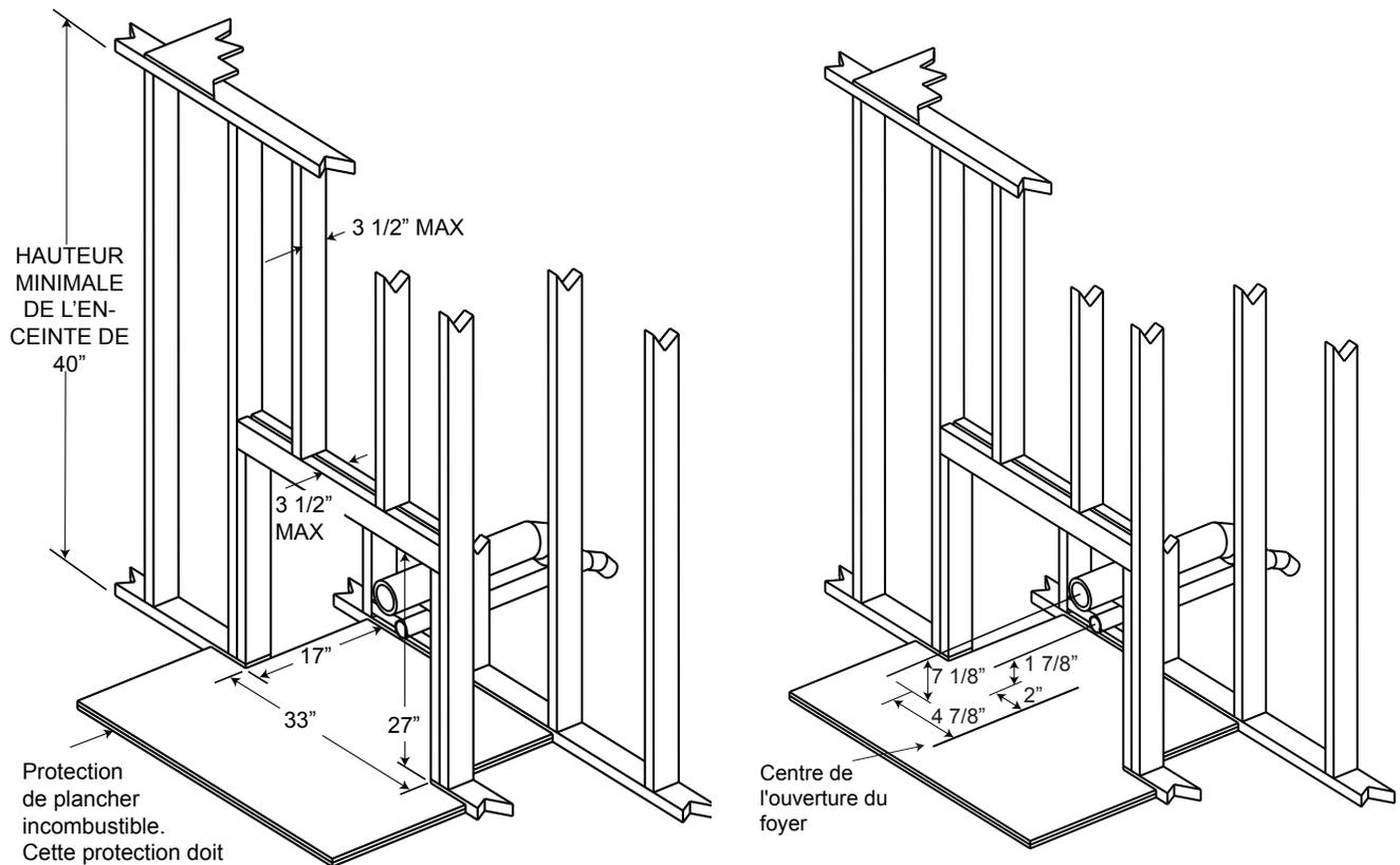
Protection de plancher incombustible. Cette protection doit avoir une valeur de résistance thermique de 0,4 (deux panneaux de béton léger de 1/2" superposés pour un total de 1" d'épaisseur, chaque panneau doit avoir une valeur de résistance thermique de 0,2).
