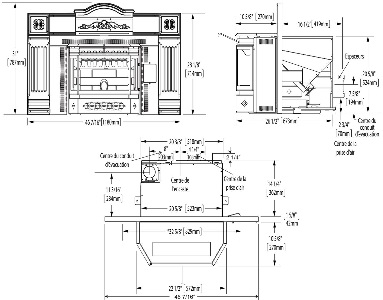
\* L'ouverture avant du foyer ou de l'enceinte doit avoir cette largeur afin de pouvoir installer le contour à égalité avec le mur fini et centré dans l'ouverture.
