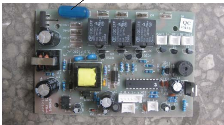
LA COUVERTURE DU FUSIBLE
