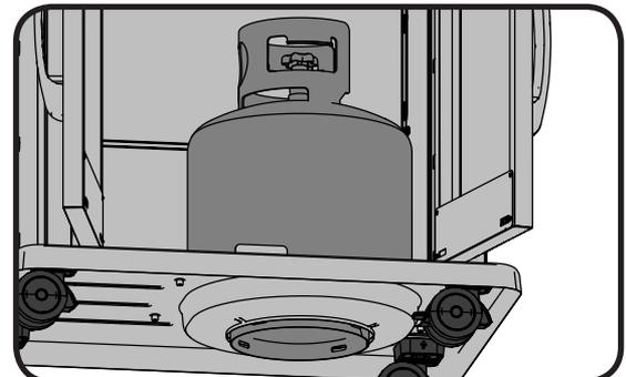
**Installation Bouteille de Propane:** Cylindre Set dans le trou dans la tablette du bas. D'autres bouteilles peuvent être acceptables à condition qu'ils s'adaptent pas correctement dans l'anneau de bassin de rétention.
