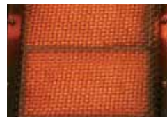
Brûleurs de cuve infrarouges (605 et 730)
