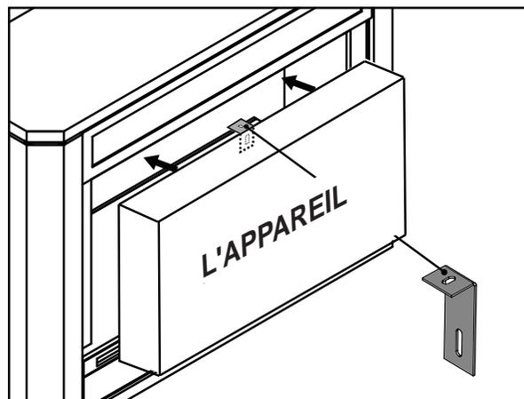
Emplacement d'installation d'appareils du fixer les support.
