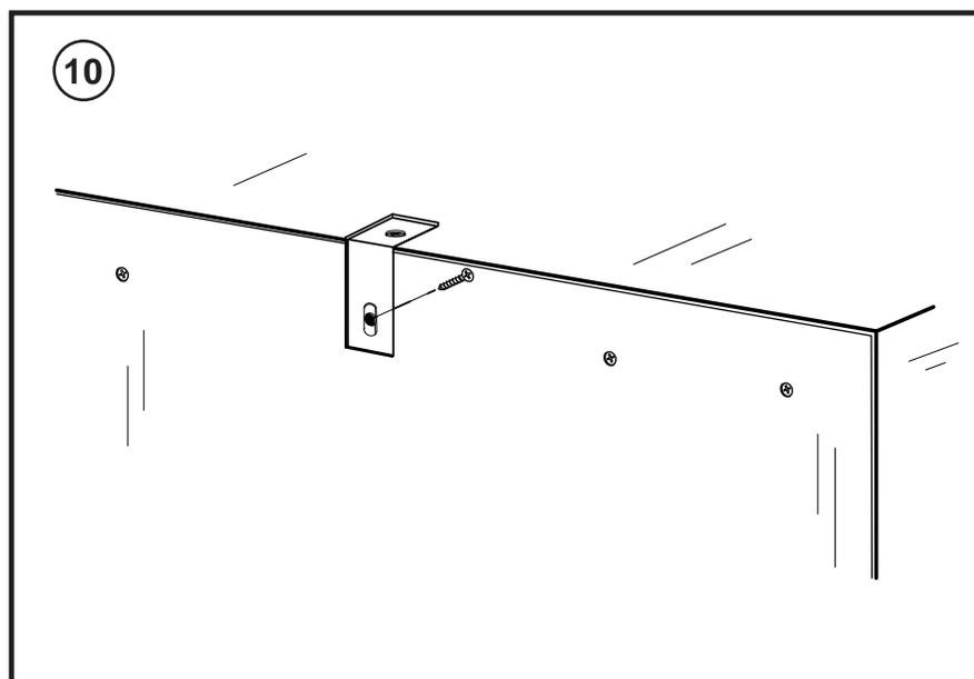
Fixez partie inférieure du support en utilisant la vis de l'étape 9.
