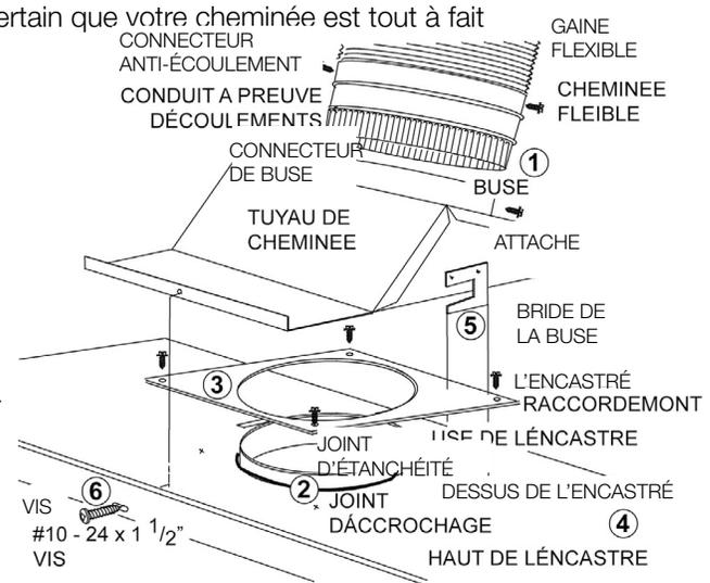
**NOTE : En plaçant une lampe de poche allumée dans la buse de l'encastré, vérifiez que le dessus de l'encastré et le connecteur de buse sont scellés hermétiquement.**
