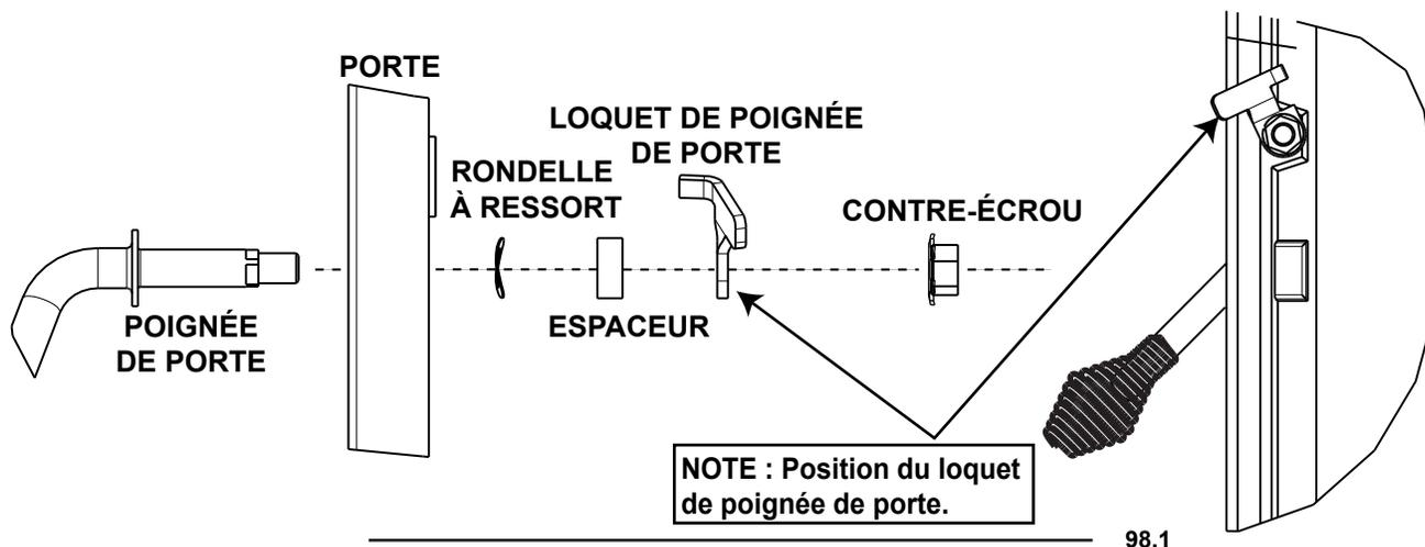
Insérez la grande poignée à ressort sur l'extrémité de la poignée de porte. Insérez la petite poignée à ressort sur l'extrémité de la tige du registre située sous la porte.
