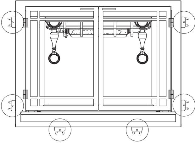
Pour installer la façade de l'appareil à égalité avec la surface finie, positionnez les montants d'ossature de façon à prévoir l'épaisseur de la surface finie. Dépliez les six supports de fixation qui se trouvent sur le dessus et de chaque côté de l'appareil et fixez-les aux 2x4. Les supports de fixation faciliteront l'installation d'une surface de finition de 1/2" ou de 3/4" d'épaisseur.
