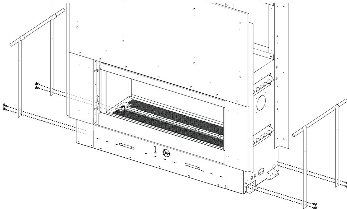
Fixer les poignées de transport au côté de l'appareil, comme illustrée avec les vis fournies. Une fois que l'appareil soit en place enlever les quatre vis fixée a chaque poignée de l'appareil. Jetez les poignées.
