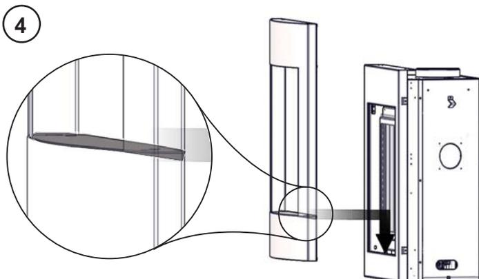
LA BRIDE INFÉRIEURE DU CONTOUR VA ACCROCHER SUR L'OUVERTURE DE L'AVANT DE L'APPAREIL.
