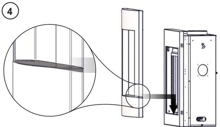
THE BOTTOM FLANGE ON THE SURROUND WILL HOOK ONTO THE FRONT OPENING OF THE APPLIANCE.
